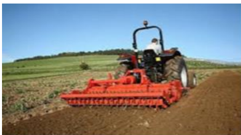
Photo2: Matériel entraîné par la prise de force du tracteur et permettant de réaliser une préparation satisfaisante du sol en un seul passage.
